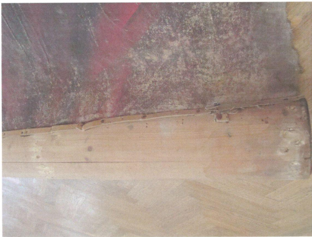
Velké trhliny při spodním okraji, dole detail uchycení na válci.
